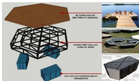
Hình 4. Cấu tạo một mô-đun cơ bản hình lục giác cạnh 2,5m (nguồn: Tác giả)
